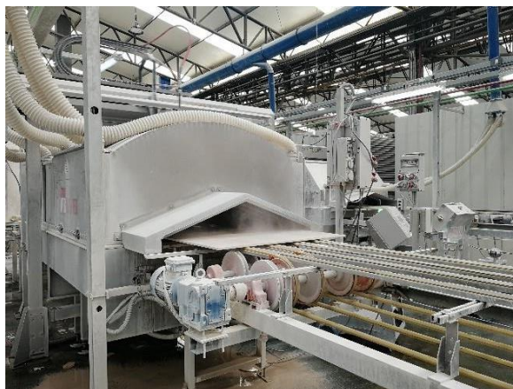
Figura 2.5 - Aplicação de vidro/esmalte
