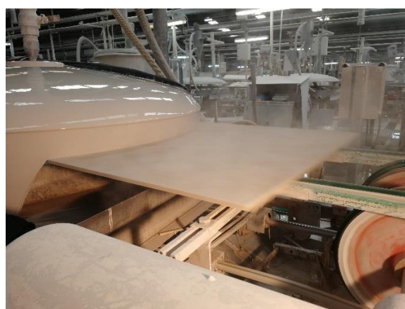
Figura 2.5 - Aplicação de vidro/esmalte
