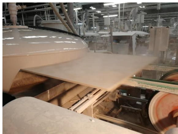
Figura 2.5 - Aplicação de vidro/esmalte
